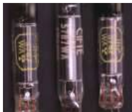
Figuur 15. Elektronenbuizen met radioactieve gloeidraad (Th-232)
