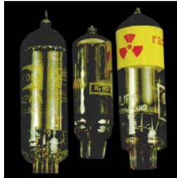
Figuur 14. Radioactieve bron in elektronenbuizen
