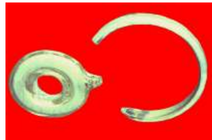
Figuur 16. Radioactieve lichtbronnen met Tritium
