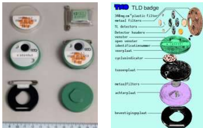
Figuur 7.7ab. De opbouw van en de TNO/TLD-badqe.
