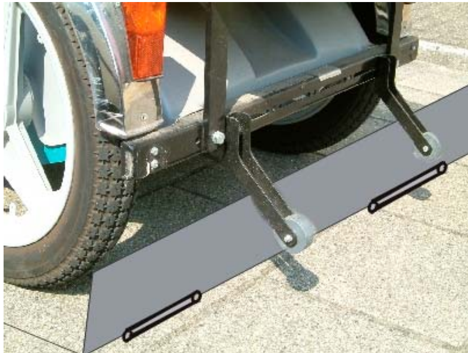
Figuur 14 Scootmobiel (1m60 x 73 cm detail), de afrijdbeveiliging komt tussen de antiekiep wieltjes en de achterwielen omhoog (plaats afrijdbeveiliging schematisch weergegeven).
