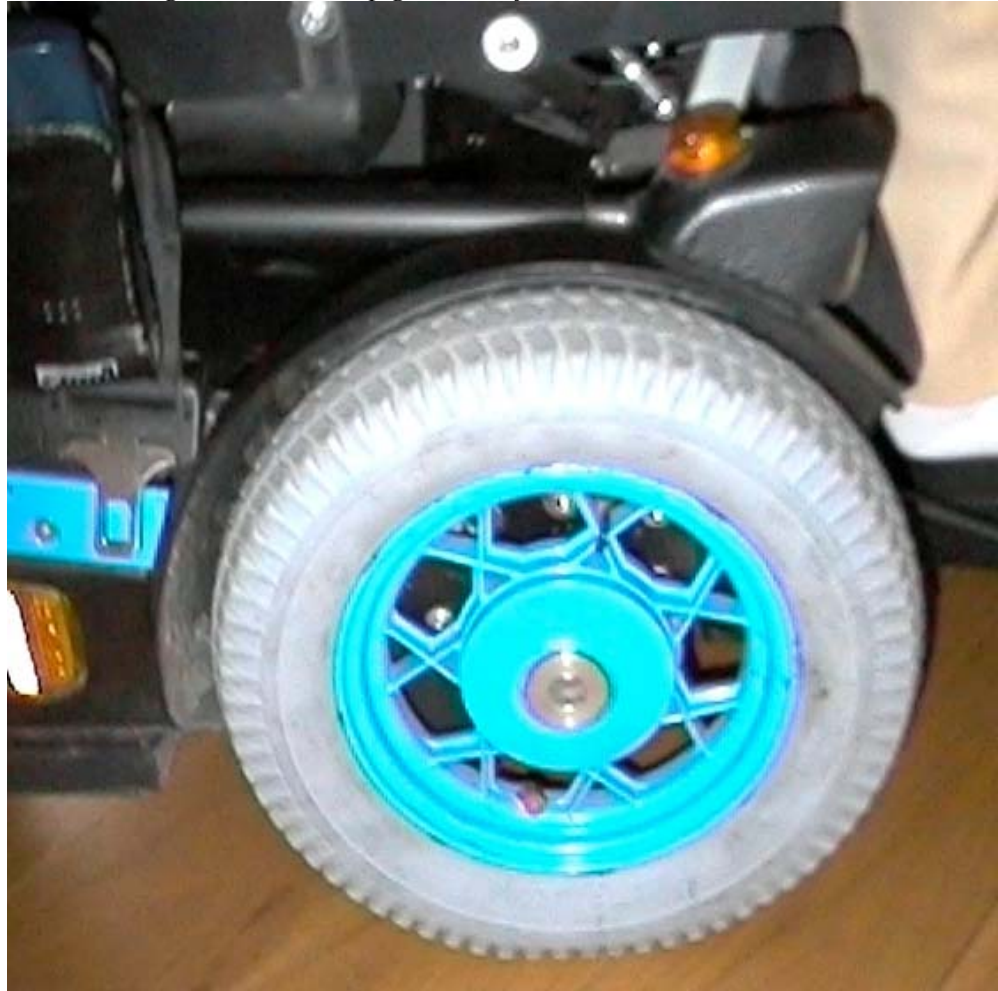
Figuur 12 Wielen, niet geschikt voor het vastzetten van de rolstoel.
